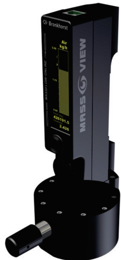
MASS-VIEW®-Durchflussregler: Vordruckschwankungen werden über ein Membranventil kompensiert.
